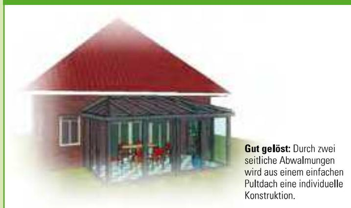
**Gut gelöst:** Durch zwei seitliche Abwalmungen wird aus einem einfachen Pultdach eine individuelle Konstruktion.
