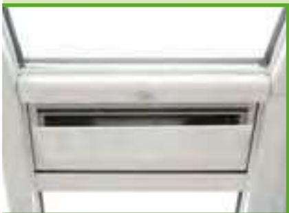
Komfortgeräte für die Be- und Entlüftung lassen sich optisch nicht störend in die Konstruktion des Wintergartens einfügen: Ein **regulierbarer Schiebelüfter** (unten oder links, je nachdem) sorgt für die Zufuhr unverbrauchter, frischer Luft und wird im Brüstungsbereich des Wintergartens positioniert, während der **Walzenlüfter** im Dachbereich für die Abfuhr erwärmter, verbrauchter Luft sorgt.
